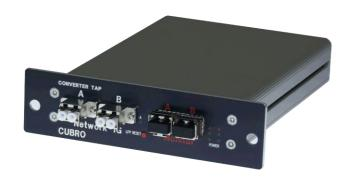
Cubro コンバータタップは、ネットワークをタップすることに加えて、インターフェースを変換するための柔軟なソリューションです。 コンバータタップには、モニタポートにSFPを備え、リンクポートに固定ポート(SXまたはLX)を備えたもの、または固定モニタポート(SXまたはLX)を備えリンクポートにSFPを備えたものの2つのバージョンがあります。後者はRバージョンと呼ばれます。
